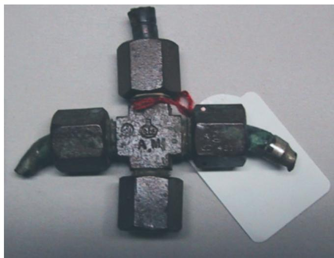
Druckluft oder Hydraulikverteiler mit brit. Krone und „AM“ (Air Ministry)
