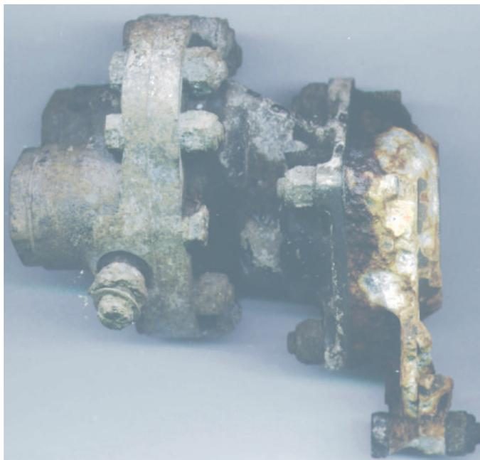
*Hydraulikpumpe (Elektromotor fehlt) zur Betätigung des oberen Turm-Abwehrstandes*
