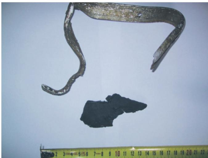
*Aluprofil und vermutlich Reifenteil aus Gummi*
