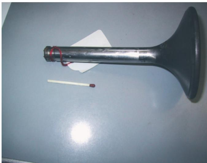
*Einzelnes Ventil eines der vier Wright „Cyclone“ Triebwerke*
