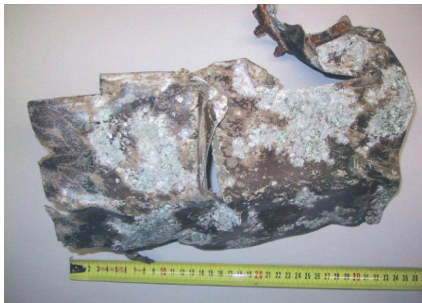
*Dasselbe Blech von aussen mit Tarnschema und ebenfalls Brandspuren*
