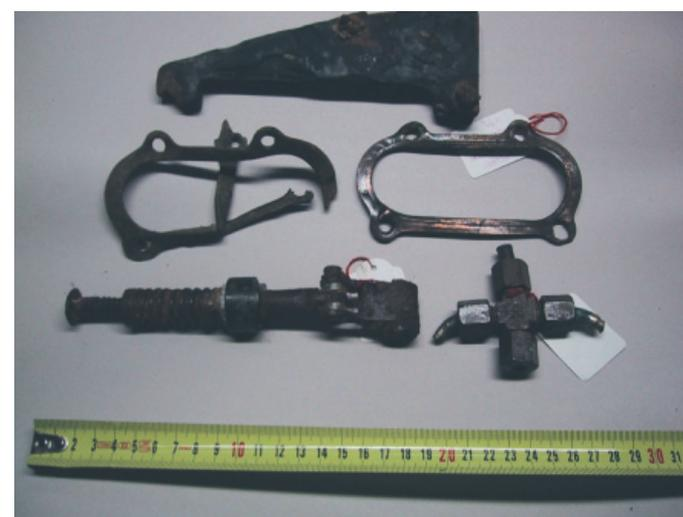
Man erkennt Auspuffdichtungen des Rolls Royce „Merlin“ Motors, sowie einen Verschlußmechanismus, Hydraulikverteiler, angekohltes Pertinaxteil
