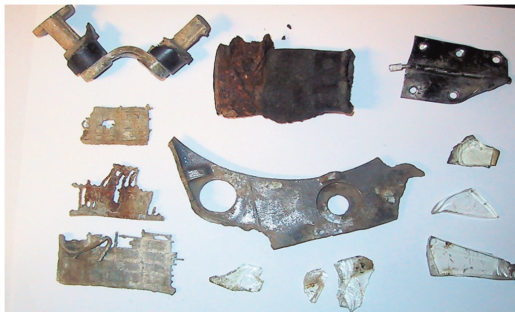
Von oben nach unten/links nach rechts: ein Pol der Bordatterie (Herstellungsdatum Feb. '44), Batterieelemente, Schlauchschelle mit Schlauch, Teil des Pratt & Whitney „Double Wasp“ Motors, Splitter von Instrumentenverglasung, unbekanntes Teil aus Cockpit, Haubenverglasung aus Plexi (Plexi)
