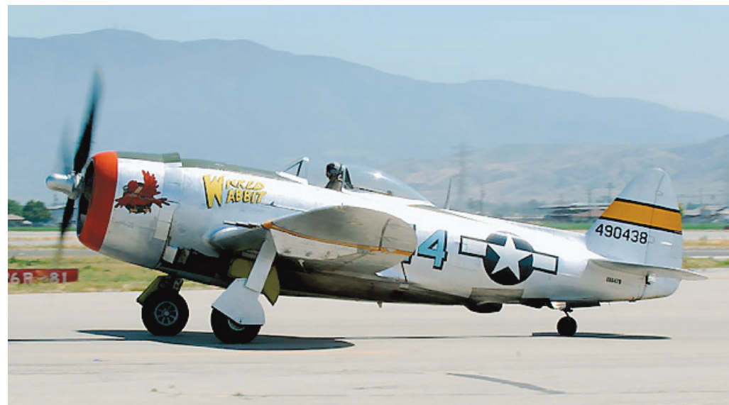
Hier ein aktuelles Foto einer flugfähigen „Thunderbolt“. Man erkennt die 4 versetzten 12,7mm MGs in der Tragfläche, das Bombenschloss, die riesige Frontpartie, die „Bubble Top“ Vollsichtkanzel, und an der Rumpfunterseite im letzten Drittel des Rumpfes den „Supercharger“ (Abgas-Höhenlader).
