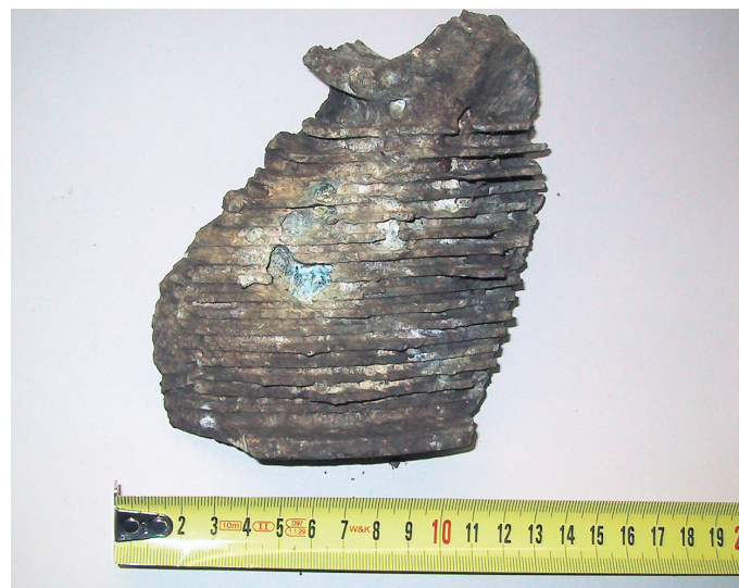
Bruchstück eines der 18 Zylinder: Kühlrippen nur noch fragmentarisch erkennbar
