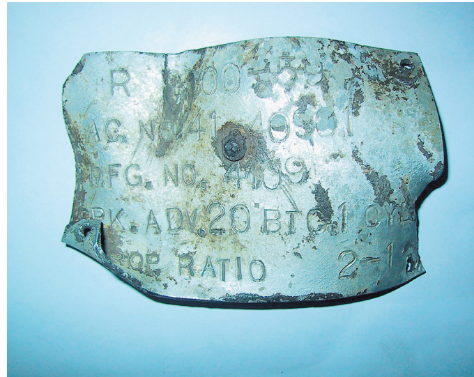
Beweisstück Nr. 1: das Typenschild des Pratt & Whitney „Double Wasp“ Sternmotors mit der Seriennummer aus dem MACR
