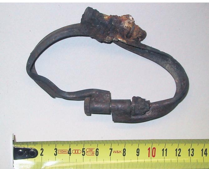
Rohrschelle der Supercharger-Abgasleitung
