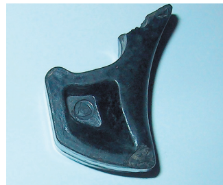
Ein besonders beeindruckender Fund: der abgebildete Bekelit-Gegenstand ist der sog. „Trigger“ (Abzug) der Bordkanonen. Der Griff des Steuerknüppels war aus Bekelit und in diesen Griff war vorn der Abzug eingebaut. Auf diesen Fund legt der Verfasser besonderen Wert, da Myers mit Sicherheit bis zu seinem Aufschlag diesen Abzug in Händen hielt.
