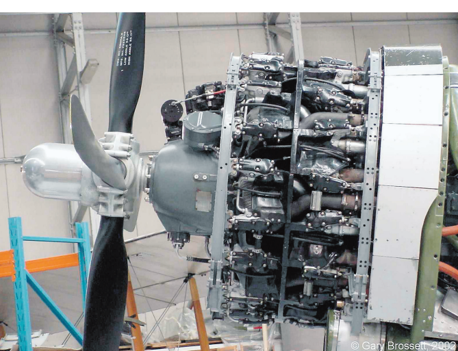
Detailansicht des gewaltigen „Double Wasp“ 18-Zyl.-Sternmotors mit Luftschaube, wie er u.a. in der Thunderbolt verwendet wurde. Er verlieh der relativ gedrungenen Maschine ungeahnte Kräfte.
